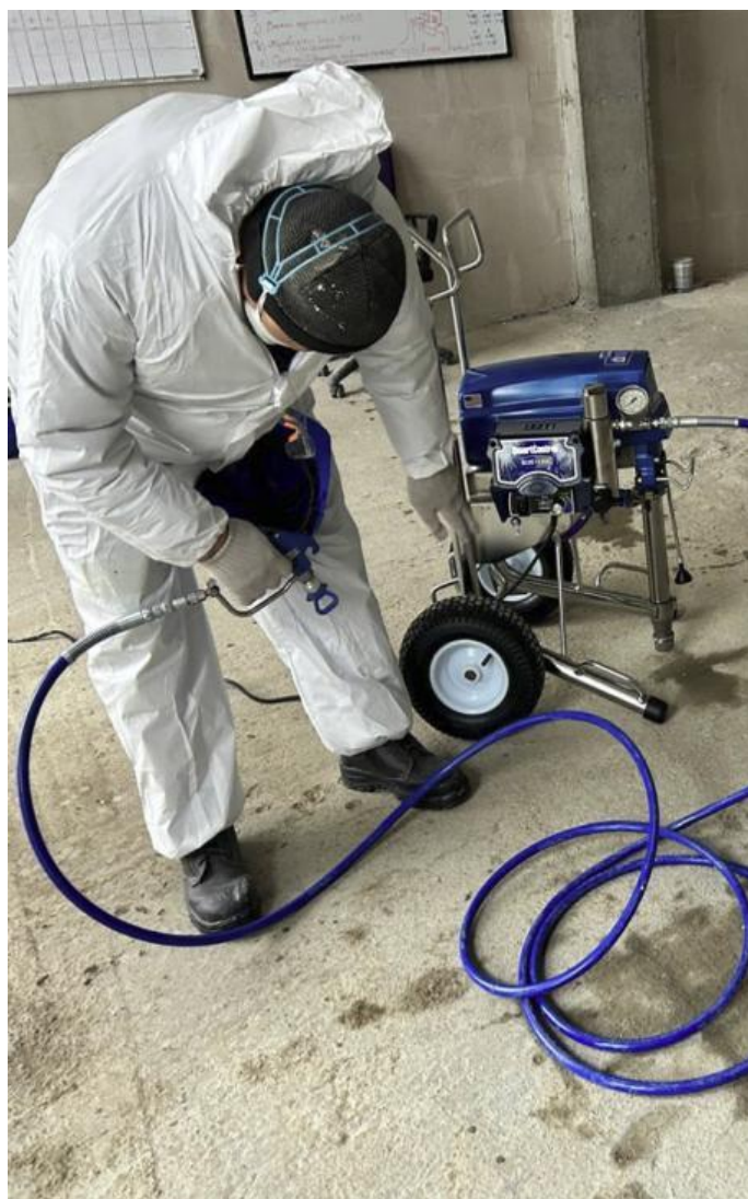
Рисунок 2.1 – Наладка оборудования безвоздушного распыления и приготовление материала а – приготовление материала, б – наладка оборудования безвоздушного распыления, в – установка материала в оборудование
